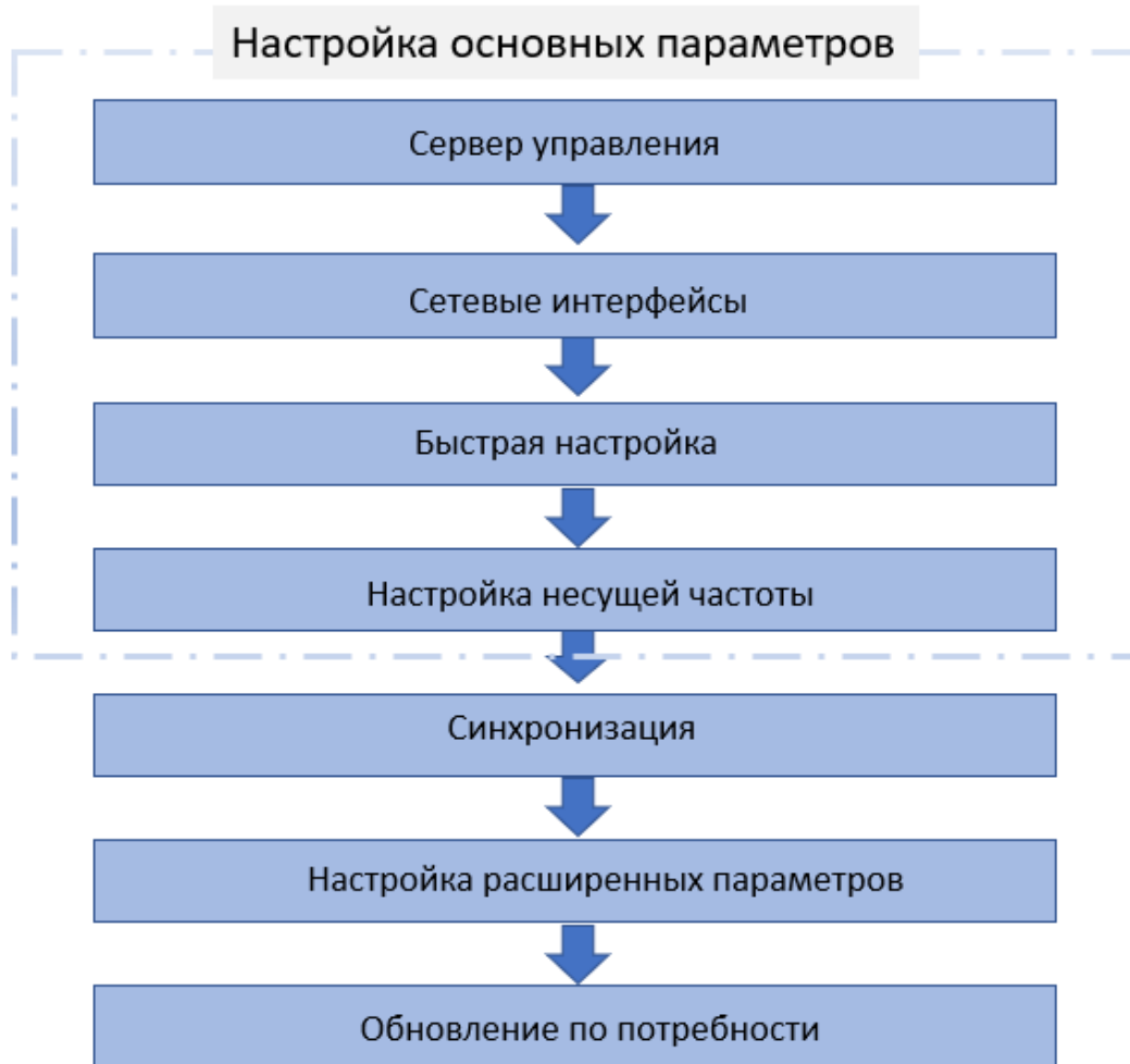
Рисунок 4 — Порядок выполнения операций при первоначальной настройке базовой станции
